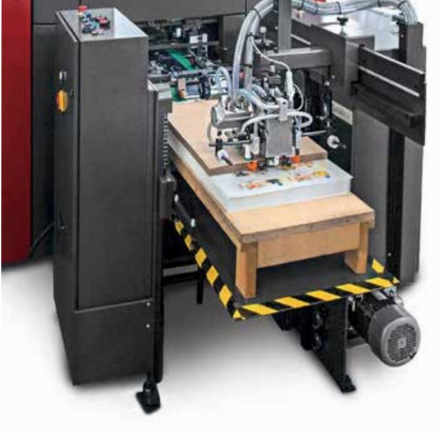
La máquina está equipada con un **ALIMENTADOR DE HOJAS DE PILA** alta capaz de alimentar cualquier tipo de material.
